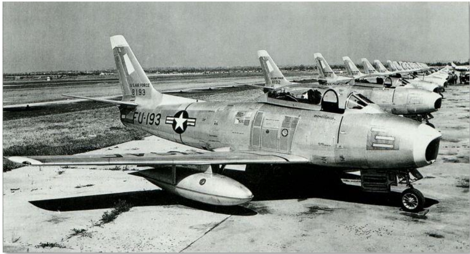
Рис. 1.10. F-86A-5 с крышками пулемётных портов и подвесными топливными баками
