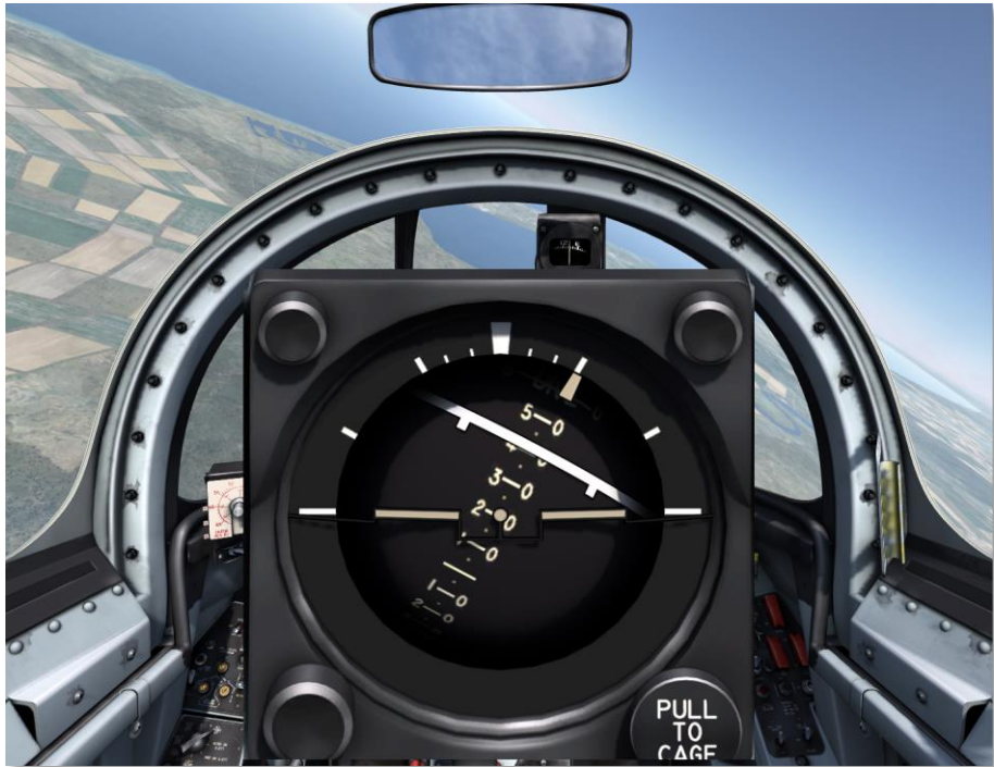
Рис. 4.9. Показания прибора при пикировании самолёта с тангажом -20^\circ и левым креном 30
