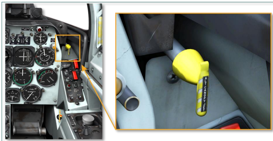
Рис. 3.11. Альтернативная ручка аварийного сброса фонаря
