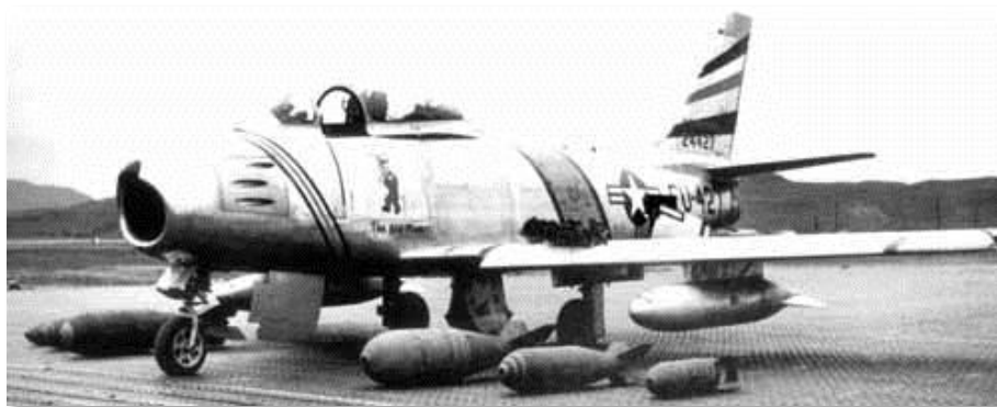
Рис. 1.26. F-86F с вариантами бомбовой нагрузки
