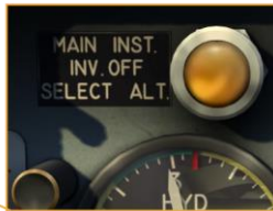
Лампа сигнализации отказа основного трёхфазного преобразователя
