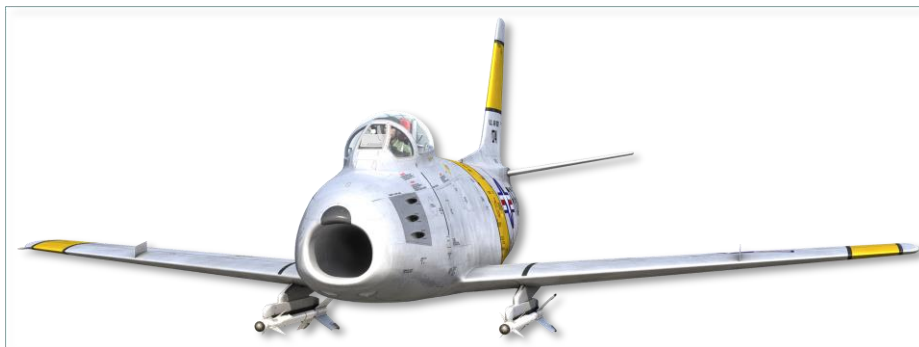
Рис. 6.16. Подвеска ракет "воздух-воздух" GAR-8
