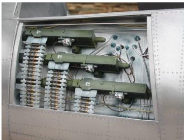
Рис. 6.4. Три пулемёта AN/M3, установленные на левом борту F-86
