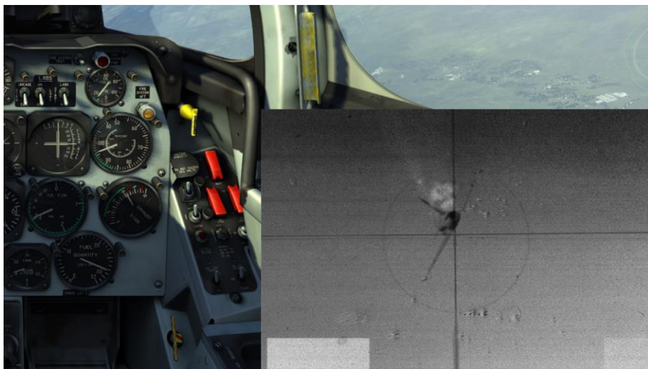
Рис. 6.23. Расположение и вид снимка фотокамеры фиксации прицеливания и результатов применения оружия
