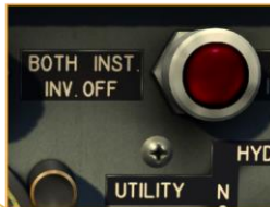
Лампа сигнализации отказа обоих трёхфазных преобразователей
