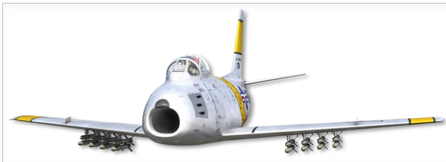
Рис. 6.12. Самолёт с 16 НАР типа HVAR
