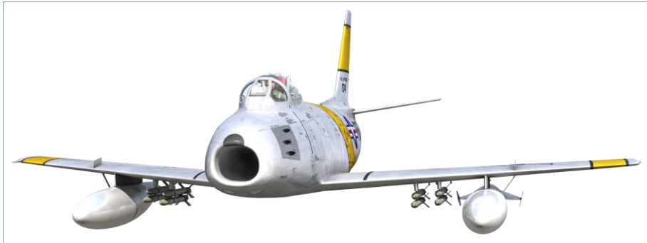
Рис. 6.13. Подвеска 8 неуправляемых ракет HVAR с баками
