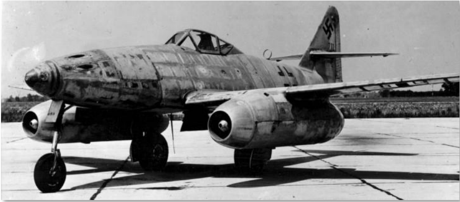
Рис. 1.2. Первый реактивный самолёт люфтваффе в истребительно-бомбардировочном варианте Me-262A-2 Швальбе (ласточка)
