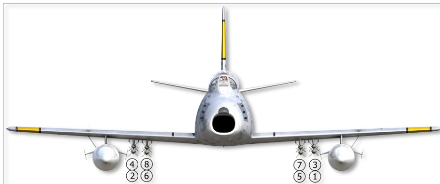
Рис. 6.15. Последовательность схода ракет при подвеске 8 HVAR
