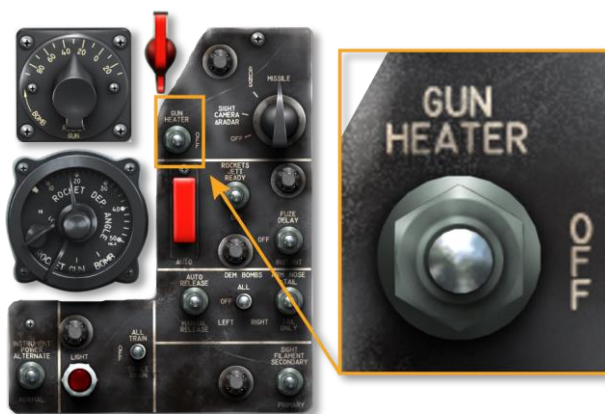
Выключатель обогрева стволов пулемётов (для предотвращения заклинивания пулемётов от обледенения при низких температурах и высокой влажности)
