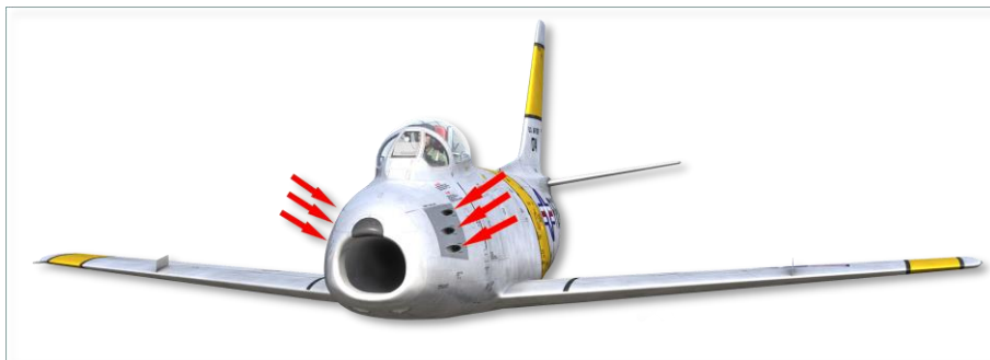
Рис. 6.3. Расположение пулемётов на борту самолёта
