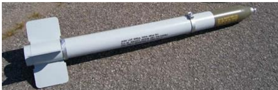
Рис. 1.18. Неуправляемая ракета HVAR калибра 127 мм
