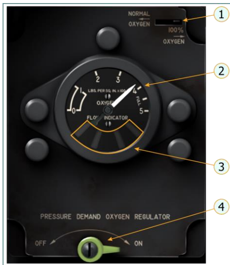
Рис. 5.14. Панель управления системой кислородного питания.
