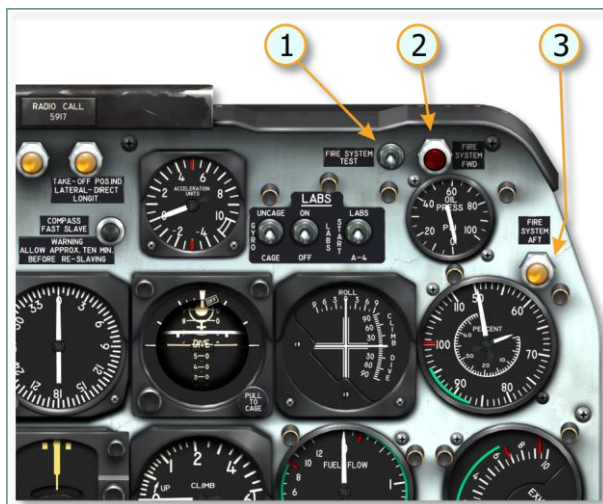
Рис. 5.10. Система сигнализации о пожаре
