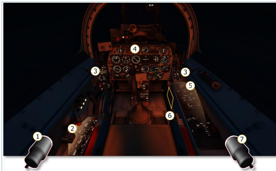
Рис. 5.15. Схема размещения источников света в кабине F-86F-35
